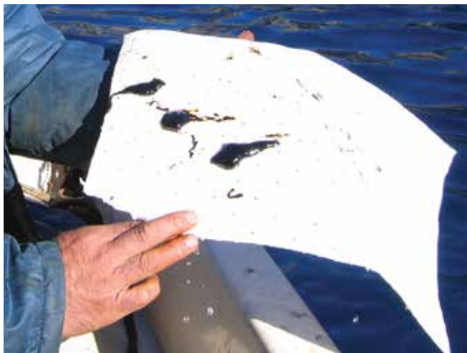
▲ Рис. 6: Сбор плавающей нефти чистым сорбционным матом.
