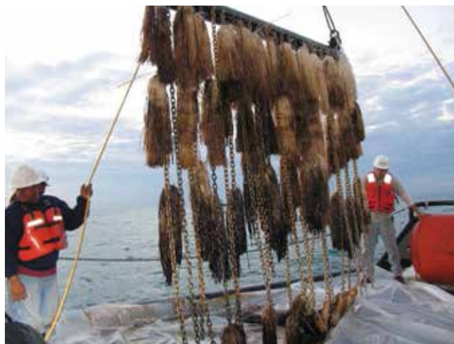
▲ Рис. 3: Применение сорбентов для отбора проб в сублиторальной зоне. Рама с прикрепленными сорбционными материалами протаскивается вдоль морского дна. Наличие нефти на извлеченном сорбенте позволяет определить территорию распространения опустившейся на дно нефти.
