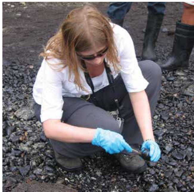
▲ Рис. 7: Отбор проб выброшенной на берег нефти.
