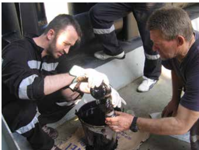
▲ Рис. 4: Сцеживание пробы бункерного топлива на борту судна, потерпевшего крушение.
