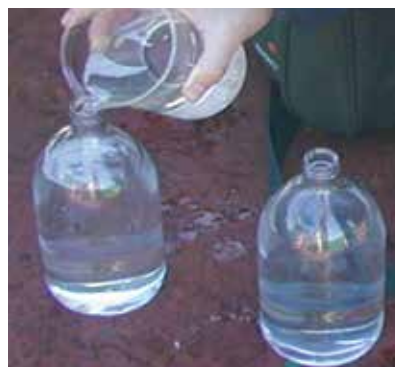
▲ Рис. 12: Узкогорлые бутылки прозрачного стекла (слева) или бутылки из полимерных материалов (справа) желательно не применять в целях мониторинга.
