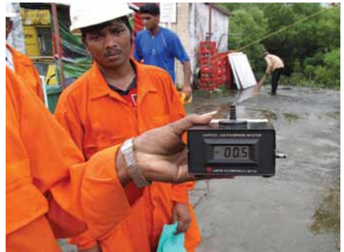
▲ الشكل رقم 14: رسم توضيحي لجهاز لرصد غاز الفوسفين محمول باليد خارج منطقة خطيرة.
