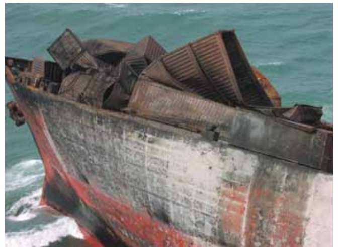
الشكل رقم 9: حاويات انهارت وتشوهت بفعل الحرارة على القسم الأمامي من مركب درجة قياسي.
