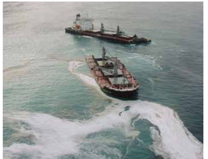
▲ 图 13: 因散装货轮出现灾难性故障而泄漏的重质燃油。货物已与油类混在一起, 因而难以估算出所泄漏油类的真实体积。
