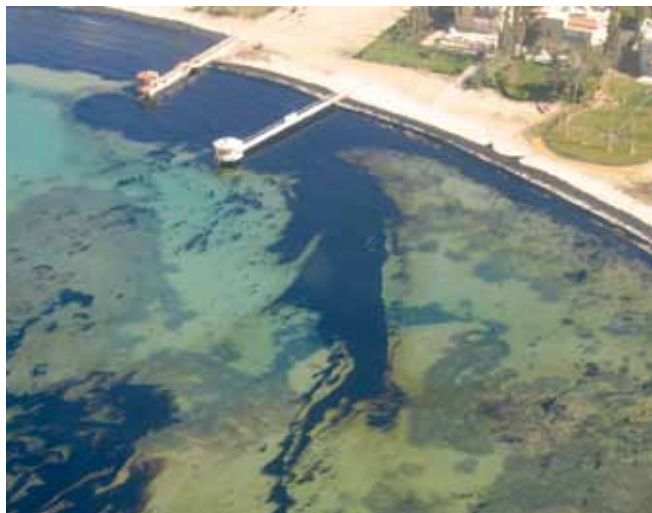
▲ 图 15：漂至海岸线的重质燃油。水底的海草和海底岩石结构可能会扰乱油量估算工作。
