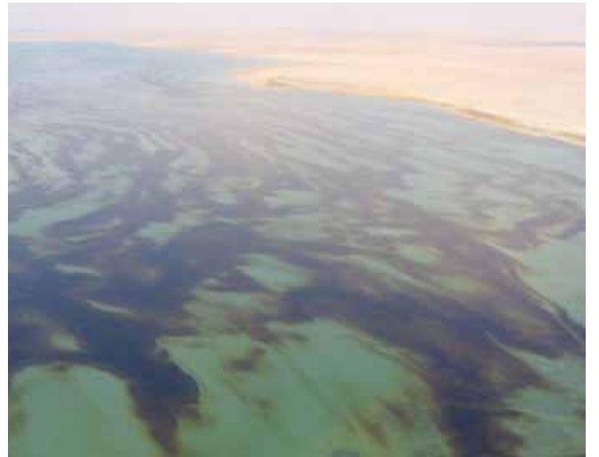
▲ 图 11: 非常大的不连贯重质燃油漂浮层 - 注意不存在油膜。
