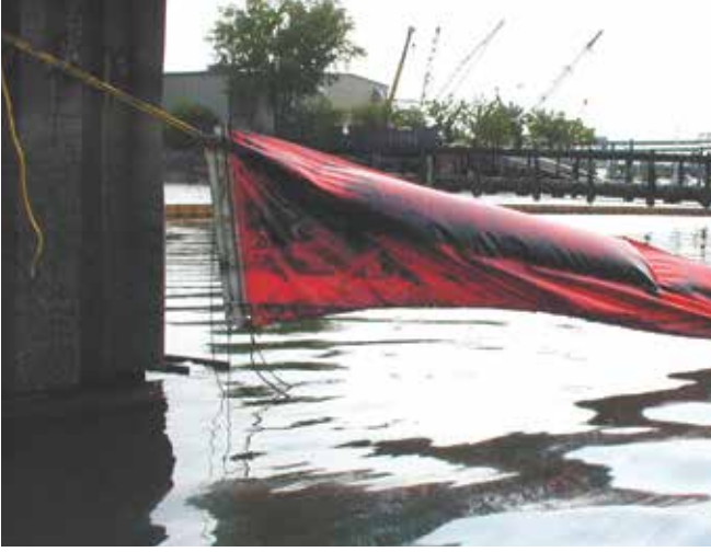
▲ Şekil 16: Uzunluğu yetersiz olan bir palamar halatının kullanılması engelin gelgitte suyun çekildiği durumda asılı kalmasına neden olmakta, petrolün altından geçmesine izin vermektedir. Gelgit döngüsünün başından sonuna kadar engelin etkili bir konumda tutulması için halatların düzenli olarak yeniden ayarlanması gerekebilir. Kayar palamar yerleri bu senaryoda daha az etkili olabilir.
