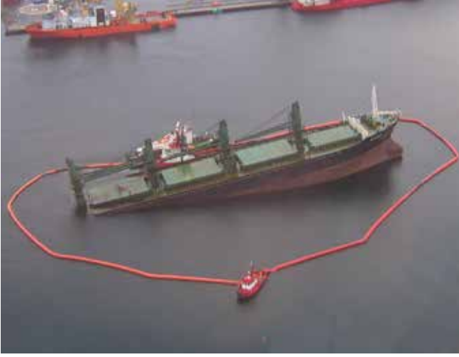
▲ Şekil 12: Gemi yakıtının herhangi bir olası sızmasının kontrol altına alınması için kısmen batmış olan bir batığın etrafına demirlenen havayla şişirilebilir engel.
