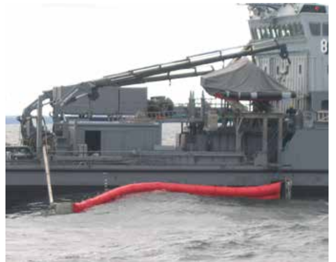
▲ Şekil 11: Dalgaların hareketini takip edebilmeye yetecek kadar esnek olmakla birlikte engel tekne gövdesine tutturulduğu yerde sudan kalkmıştır, potansiyel olarak petrolün tepe noktasından kaçmasına olanak sağlamıştır
