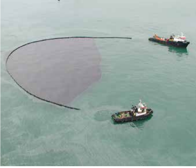
▲ Şekil 8: Ağır bir ham petrolün kontrol altına alınması için iki gemi arasında bir "U" yapısal düzenlemesinde yerleştirilen havayla şişirilebilir engel. Petrolün geri alınması işlemi başarılı bir şekilde sonuçlandırılmaktadır.
