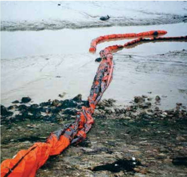
▲ Şekil 5: Bir engel yerleştirildiğinde kolaylıkla hasar görebilmektedir. Gelgit döngüsünün başından sonuna kadar verimliliğinin sağlanması için düzenli bakım gerekmektedir.
