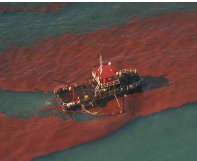
▲ Şekil 10: Aşırı derecede süsüleşmiş ham petrolde, bir petrol toplama katamaranından yerleştirilen uzunluğu kısa olan bir perde engelin kullanıldığı tek gemili toplama sistemi.
