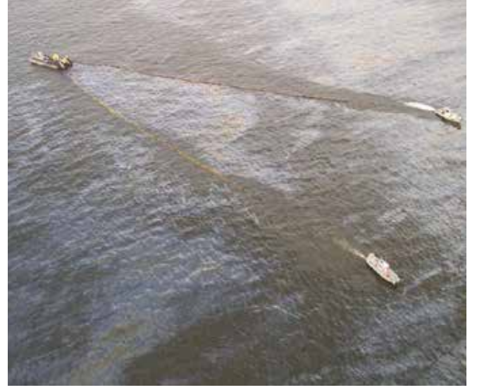
▲ Şekil 9: Tepe açısında ayrı bir süpürme gemisiyle iki çekme gemisi tarafından bir "V" yapısal düzenlemesinde uygulanan perde engel.
