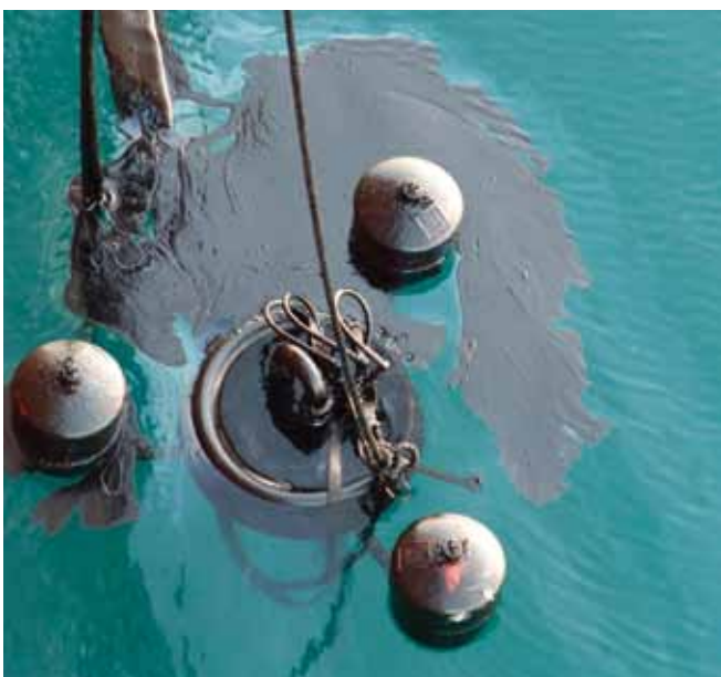
▲ 图 10: 工人们正在将软管连接到直接插入油类中的真空泵。在这种情况下, 拆除了所连接的小型导流坝, 以使粘稠的液态油类能够流入软管中, 但可能会因此而导致附连水增加。
