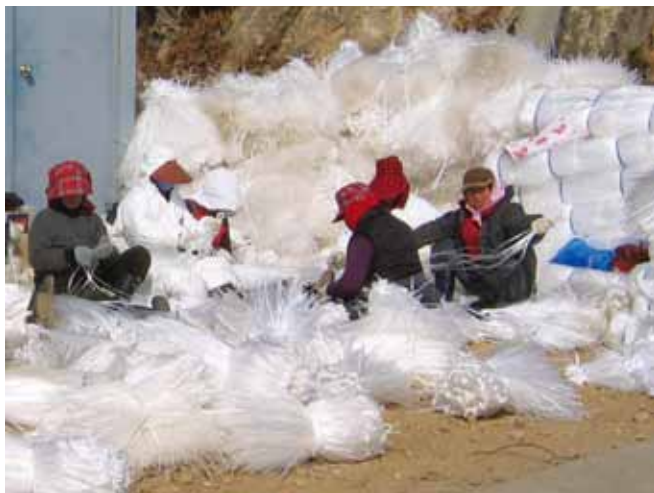
▲ 图 6：当地村民使用聚丙烯条制作溢油吸收丝团。采用当地可用材料制作的吸油物在价格及运输效率方面非常经济高效。
