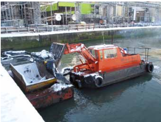
▲ 图 35: 自力推进型船, 通常用于回收港口中的残骸。在该图中, 由于温度低且油类的倾点很高, 油类变成半固态, 因此需要用勺和抓斗将油类回收到漂浮的槽车中。
