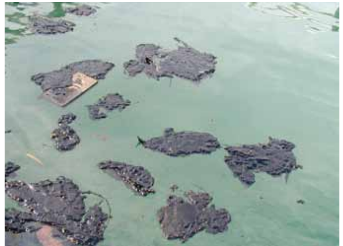
▲ 图 3: 在低于倾点的温度条件下泄漏到海中的油类形成半固态碎片状。此图显示的是倾点为 +33°C 的 Nile Blend 原油在温度为 28°C 的海水中的情况。这种油持久性很强，可以漂移很远的距离。
