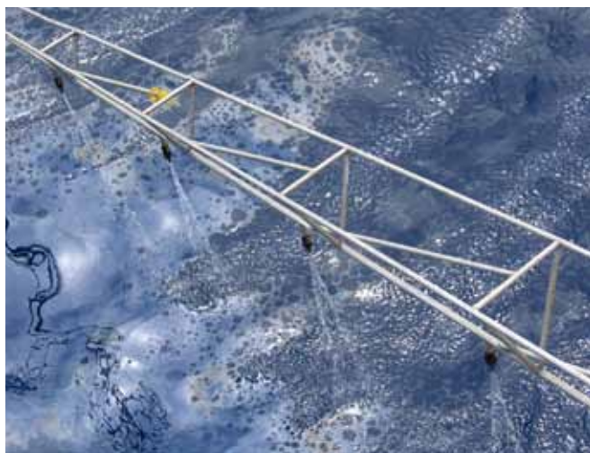
▲ 图 7：从安装在船上的喷洒臂对油膜施用消散剂，从而导致油类成群移动，而非消散。
