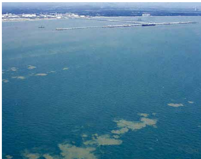
▲ 图 17：浅海水域被水流冲乱的悬浮物卷流，与成片的乳状轻质原油十分相像。
