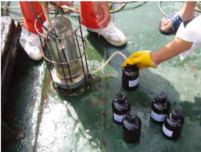
▲ 图 8：将水样从样本采集设备中轻轻倒入玻璃瓶中，以获得拆分样本。
