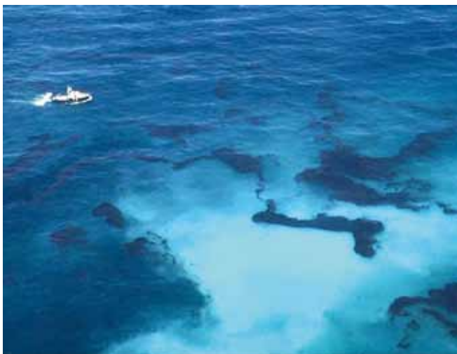
▲ 图 5：用消散剂处理重型燃油时不起作用，这种情况下所表现出来的特征是在水中形成一个白色的股流。油类依然不受影响。
