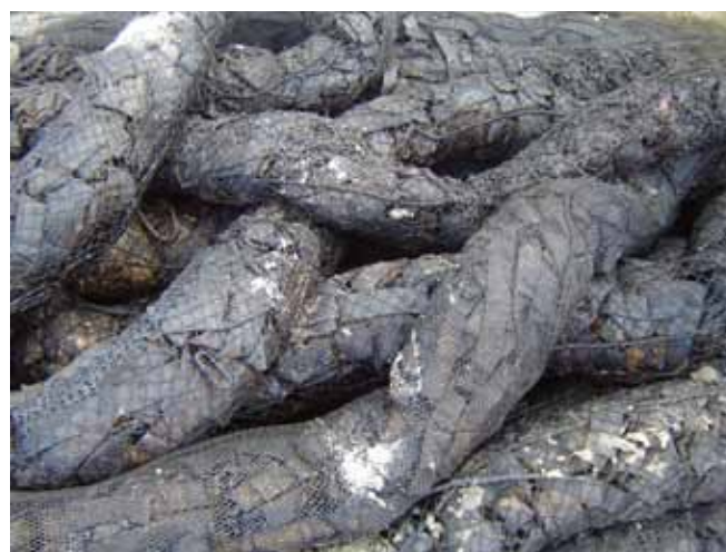
▲ 图 3：封装在编网中的聚丙烯条。浮木档栅松散的不均匀结构能够让油类轻松穿透结构，从而让内表面能够吸附油类，但封装编网很容易损坏。
