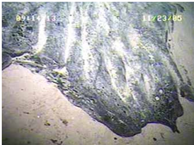
▲ 图 11：从一艘损坏的驳船泄漏到海底的一种非常重的燃油。这种油的 ^{\circ}\text{API} 为4，换算成比重就是1.04，相比之下，海水的比重为1.025（供图：NOAA）。
