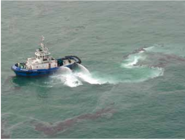
▲ 图 14：油类粘度高导致施用消散剂不成功，这可以从油类周围的消散剂所形成的典型白色股流看出来。
