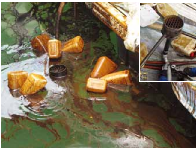
▲ 图 14: 用塑料瓶和金属边角料制成的简易导流坝撇浮装置, 此装置与真空泵相连。使用此装置可以进行基本回收, 并且可以通过去除和增添瓶子来对它进行调整。
