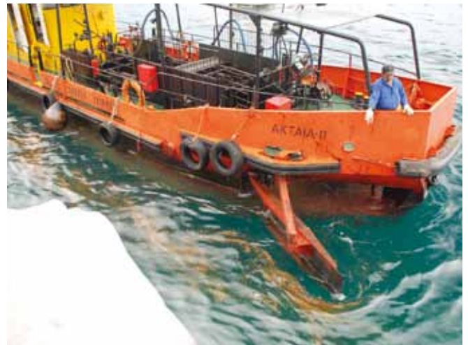
▲ 图 1：一台自力推进型导流坝撇浮装置，供在港口和近岸水域中使用。船首门已打开，以增大扫过的油带宽度并使浮油能够进入。回收到的油类会泵送到一个内部储放罐中。
