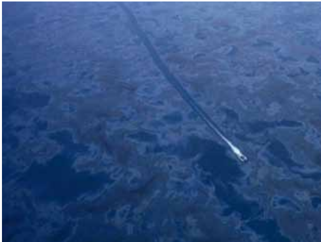
▲ 图 19：随着油类扩散并开始破裂，遇油率会降低，从而需要付出更大的努力才能回收。
