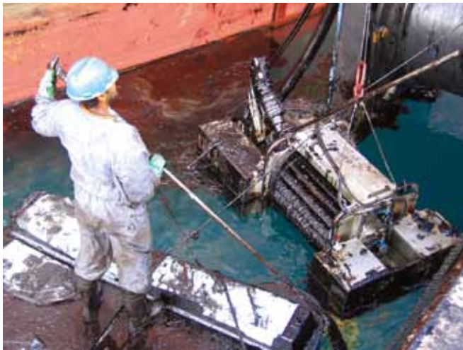
▲ 图 17: 在港口区域中部署的机械筒式撇浮装置。转动筒上的齿会将油类拉向该装置, 以便将其回收并泵送到储放容器中。该筒用筛网制成, 以最大限度地减少回收到的水。
