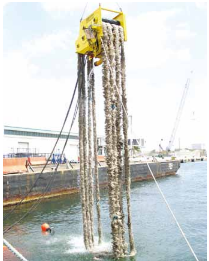
▲ 图 5：自由漂浮的刷式撇浮装置。油类附着在转动的成组刷子上，并从水面上被提起。用一个梳子将油类从刷子上清除到存储容器中。刷子背后的推进装置将浮油推向撇浮装置以提高遇油率和吞吐量（图片由 Lamor 惠供）。
