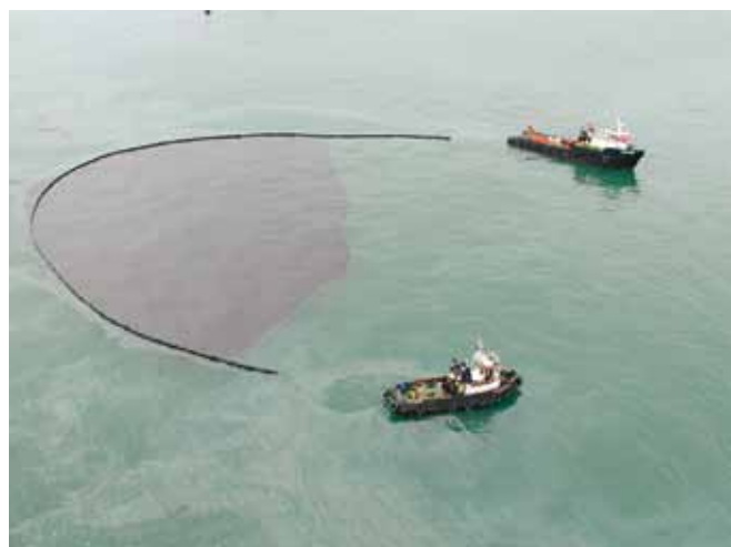
▲ 图 5：虽然油类得以成功围堵，但如果没有从水面回收的方法并配备油类的临时储放设施，这些工作可能会毫无意义。
