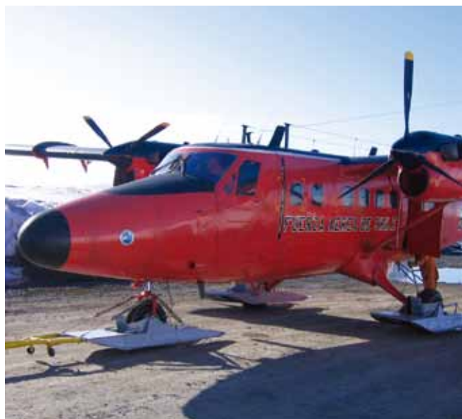
▲ 图 2：机翼上置的双引擎固定翼飞机是从空中观察海上油类情况的理想平台。对于在较靠近海岸的地方执行的观察，采用直升机可能更可取，因为直升机机动性更高、速度较低。
