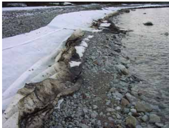
▲ 图 5：连续形态的扁平吸油物（如海岸线上放置的吸油板）具有高表面积 - 体积比这一特征。以这种方式大规模使用吸油物时，应该对产生的大量未沾油的废物的情况加以考虑。
