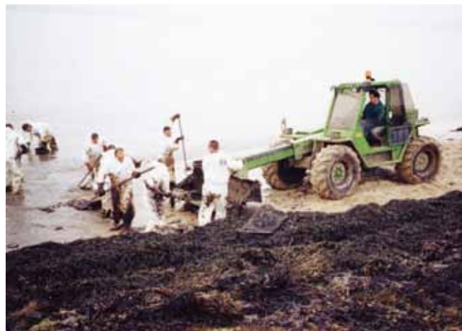
▲ 图 8：人工将油类及沾油海草清除到一个可伸缩的挖斗中。采取这种方法进行清理时可以选择含油物质而不选干净物质，从而最大限度地减少了废物量。
