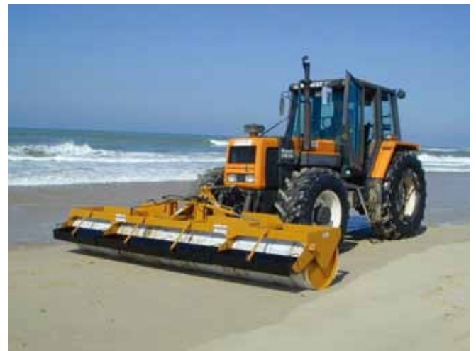
▲ 图 36：安装在拖拉机上的亲油性筒式撇浮装置，用于在结构紧密的沙滩上回收新鲜油块（图片由 Le Floch D 污染惠供）。
