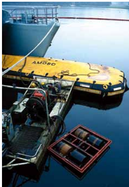
◀ 图 26: 将油类回收到充气式储油驳船的筒式撇浮装置。
