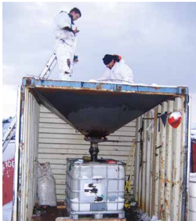
▲ 图 16: 一个简易废物过滤系统, 回收油流过带格子的漏洞来滤除残片。
