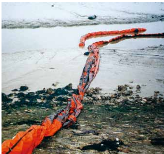
▲ 图 5: 栅栏在部署后很容易遭到破坏。需要定期关注, 以确保在整个潮汐周期内它一直发挥效用。
