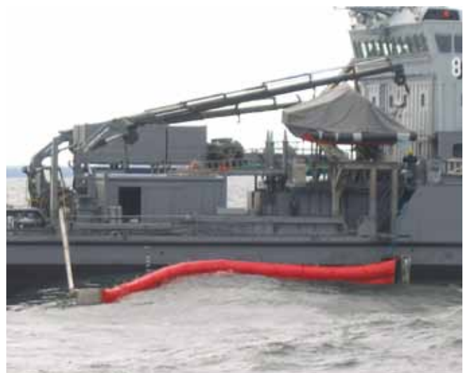
▲ 图 11：虽然栅栏足够灵活，可以随波浪的运动而起伏，但在它与船体连接处的水域，它已升到水面之上，因而有可能会使油类从顶点位置逃逸。
