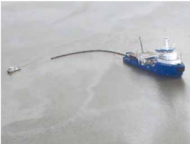
▲ 图 29：以 U 字形拖拽的栅栏，带有一个从主回收船部署的撇浮装置。
