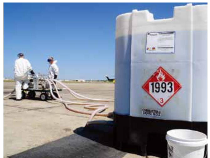
▲ 图 12：使用规格为 1m 3 的中型散装容器 (IBC) 可以直接存放和搬运消散剂。(图片由 USCG 惠供)。
