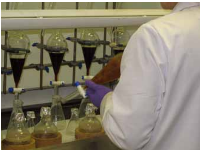
▲ 图 13: 使用分离漏斗对油类样本进行萃取(图片有 CEFAS 惠供)。
