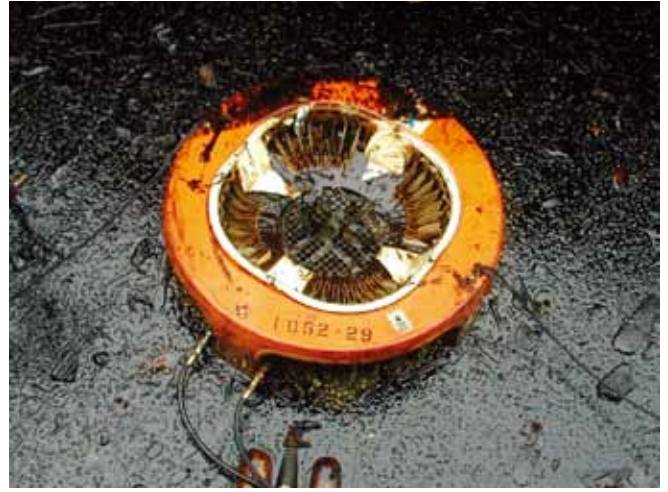
▲ 图 15：盘式撇浮装置可以成功回收刚刚泄漏的轻质原油。不过，如果油类严重乳化，那么回收作业的有效性将会降低，因为乳状液无法附着在盘上。
