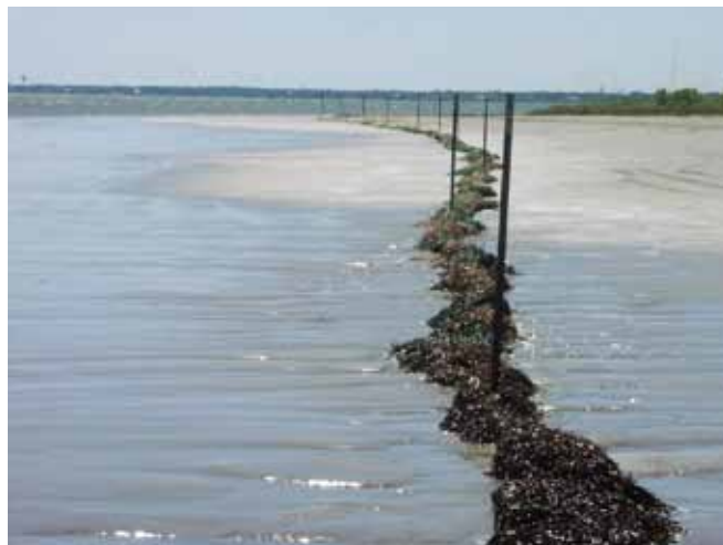
▲ 图 7：溢油吸收丝团排成一列在河口捕获漂浮油。材料的开放结构和大表面区域尤其适合于回收粘性油类。
