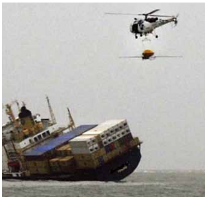
▲ 图 11：一架在机翼下方带有喷洒系统的直升机正在接近刚刚发生燃油泄漏的现场。为了有效果，有必要从较低的高度进行施用。（图片由印度海岸警卫队惠供）。
