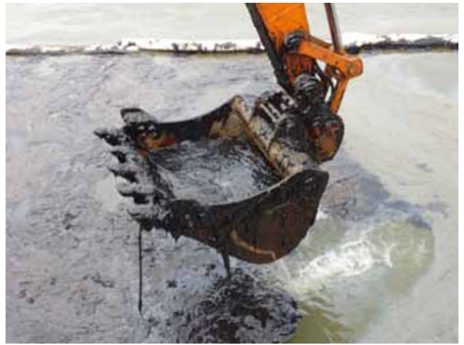
▲ 图 21: 使用挖掘机回收高粘度燃油。通过指示操作员将挖斗在水面上方稍微悬停一段时间,使附连水流掉,最大限度地提高了所回收到的油类的浓度。这样做以牺牲回收效率为代价降低了后续的处置成本。
