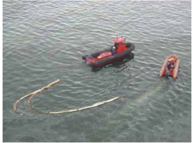
▲ 图 12：吸油浮木档栅被两艘船拖曳成“U”形，以回收海上的油光泽（非常薄的油膜）。被海水浸透而饱和浮木档栅可能会令其有效性受限，而浮木档栅缺少裙边可能会限制其抑制油类的能力。在这里，可以看到油从浮木档栅溢出。
