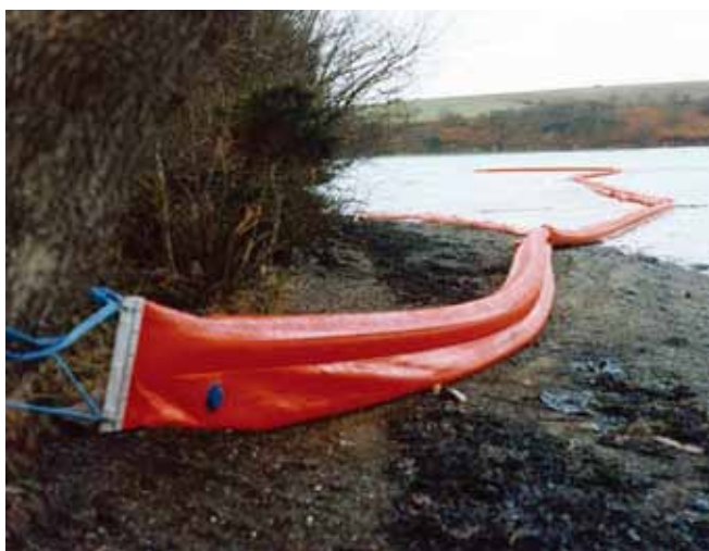
▲ 图 18: 在河口部署的可紧贴海岸线的栅栏。下部的充水式镇重腔室可使栅栏在低潮时紧贴在海岸上。在这种情况下, 可紧贴在海岸线上的栅栏的各个分段与充气型帘式栅栏的各个分段连在一起。
