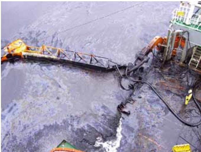
▲ 图 33: 通过液压吊车连到回收船体上的僵硬扫臂。低干舷以及遇到的汹涌浪潮会使甲板上的船员面临危险(图片由 WSA Cuxhaven 惠供)。
