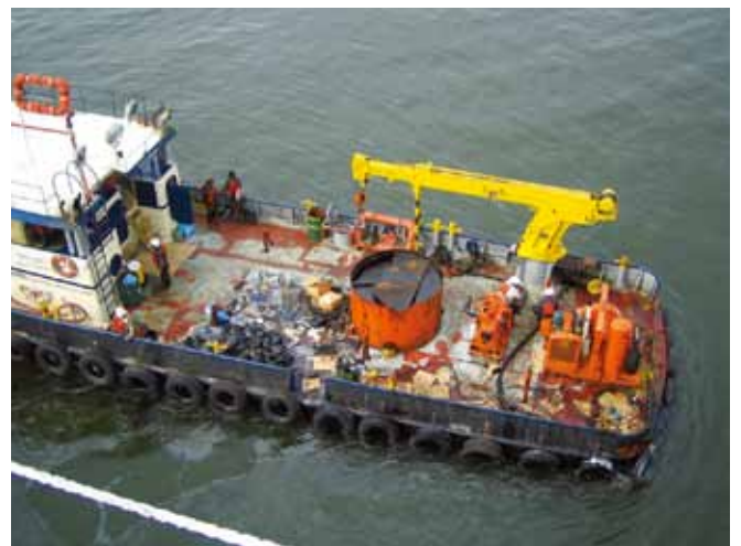
▲ 图 24：一艘作业船，其甲板上用来储放回收的油类的空间十分有限。
