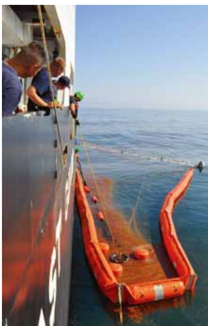
▲ 图 29：以 U 字形拖拽的栅栏，带有一个从主回收船部署的撇浮装置。
