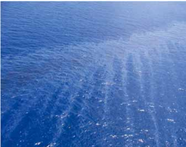
▲ 图 10: 在图片上从左到右可以观察到一条黑色油带。沿横向方向吹拂这些油类的风正在将这条油带吹离观察员, 从而形成与这条油带垂直的多排各式各样的油膜。
