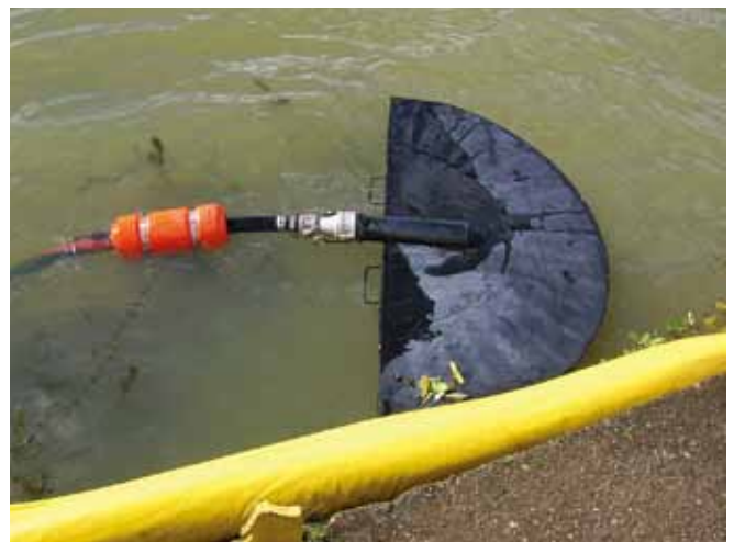
▲ 图 11: 与真空泵相连的固定导流坝撇浮装置。通过该装置头部边缘处的几个小型入口, 可以有选择性地回收油类。适合在残骸极少的平静水域使用 (图片由 Lamor 惠供)。
