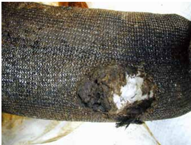
▲ 图 4：连续、均匀的吸油浮木档栅表面切开后发现未充分利用。内部仍然未沾油，可能是由于部署时间不够，或者由于油类粘性太高而不能穿透结构所致。
