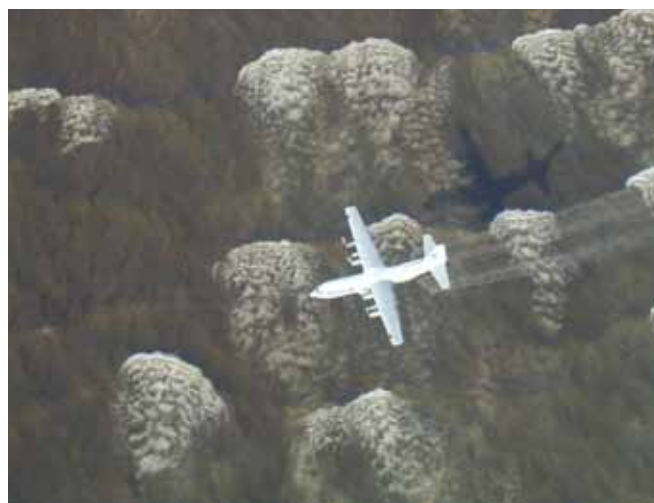
▲ 图 10：从一架多引擎飞机施用消散剂。在该图所示的情况下，认为在浅水域施用消散剂是有益的。
