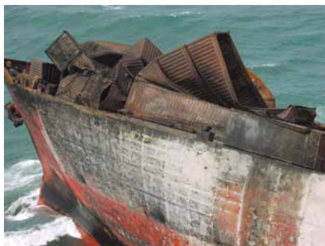
▲ 图 9: 标准滚装船的船头部分起火释放的热量导致集装箱被压扁和变形。
