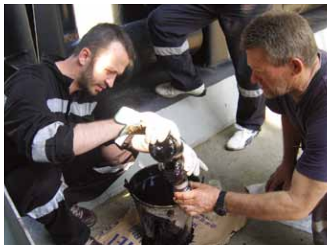
▲ 图 4：在事故船舶的船上轻轻倒出燃油舱燃油源油样本。
