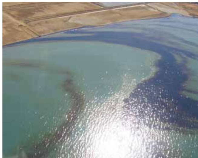
▲ 图 21: 航拍时从海面上发生的光线反射有时会成为问题; 紫外线 (UV) 和偏振滤光镜可能有助于提升油类的视觉清晰度。
