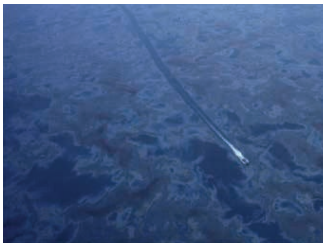
▲ Figura 19: a medida que los hidrocarburos se extienden y comienzan a fragmentarse, la tasa de encuentro se reduce y se necesita un mayor esfuerzo para la recolección.
