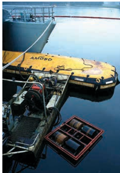
◀ Figura 26: skimmer de tambor recolectando hidrocarburos hasta una barcaza de almacenamiento inflable.
