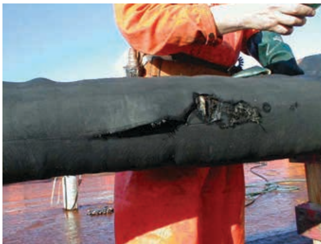
▲ Figura 23: manguera estallada como resultado de la excesiva presión interna del bombeo de hidrocarburos muy viscosos (imagen gentileza de NOFO).
