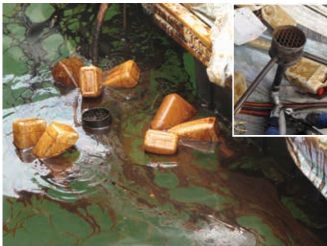
▲ Figura 14: skimmer tipo vertedero improvisado construido con botellas de plástico y recortes, conectado a una bomba de aspiración. Este dispositivo permite una recolección rudimentaria y puede ajustarse mediante la retirada o incorporación de botellas.
