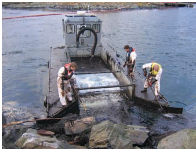
▲ Figura 34: skimmer tipo vertedero autopropulsado recolectando hidrocarburos en una entrada rocosa protegida. El poco calado de la embarcación permite trabajar cerca de la orilla. Los operarios asisten moviendo los hidrocarburos hacia la boca del vertedero.
