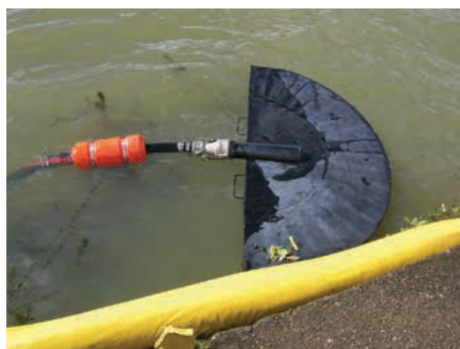
▲ Figura 11: skimmertipo vertedero fijo conectado a una bomba de aspiración. Diversas entradas pequeñas en el borde del cabezal permiten recolectar hidrocarburos selectivamente. Para uso en aguas calmadas con una cantidad mínima de desechos (imagen gentileza de Lamor).
