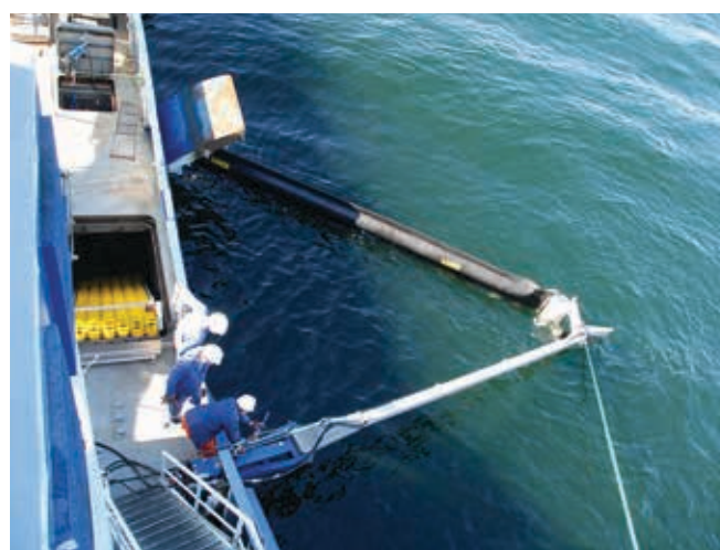
▲ Figura 32: sistema de recolección integrado en una única embarcación. La barrera almacenada en un compartimiento en el costado de la embarcación se despliega a través de una abertura mediante una grúa instalada a bordo. La abertura también permite que el skimmer de a bordo recolecte los hidrocarburos arrastrados; en este caso se compone de seis conjuntos de cepillos en una configuración de cinta transportadora (imagen gentileza de Lamor).
