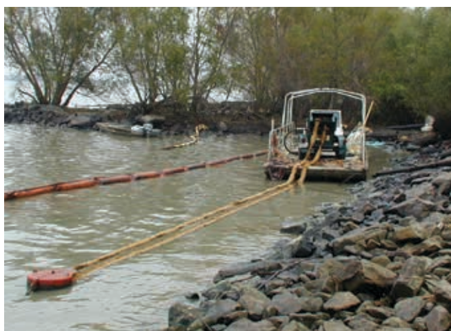
▲ ▶ Figuras 6 y 7: skimmers oleofílicos de cuerda horizontal y vertical. Los bucles adsorbentes entretreídos forman una cuerda continua que flota sobre la superficie a la que se adhieren los hidrocarburos. Se tira hacia atrás de la cuerda hacia un rodillo y los hidrocarburos se escurren hasta un depósito de almacenamiento. Los skimmers de cuerda oleofílica resultan útiles para recolectar hidrocarburos entre desechos, hielo y otras sustancias.
