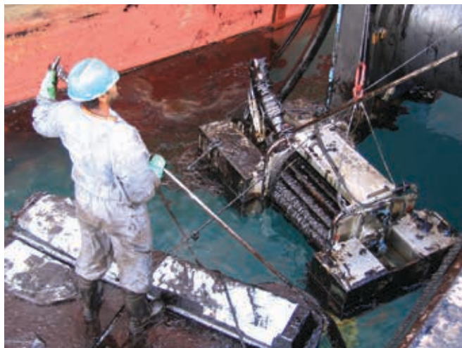
▲ Figura 17: skimmer de tambor mecánico desplegado en un área portuaria. Los dientes en el tambor giratorio arrastran los hidrocarburos hasta el dispositivo, donde se recolectan en el tambor y se bombean al almacenamiento. El tambor se construye de malla para minimizar la recolección de agua.
