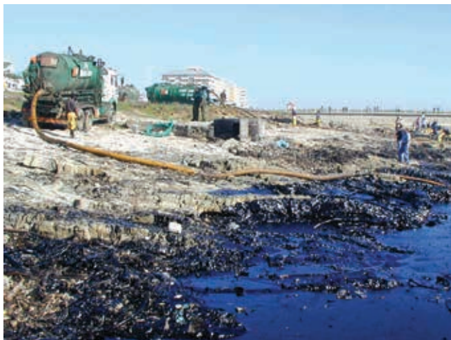
▲ Figura 8: La amplia disponibilidad de sistemas de aspiración los convierte en los dispositivos más idóneos para recolectar hidrocarburos en la costa o cerca de la costa.
