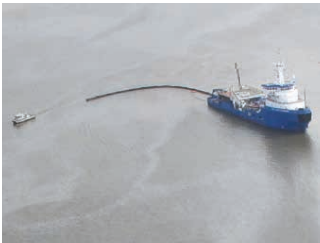
▲ Figura 29: barrera remolcada en una configuración en U con un skimmer desplegado desde la embarcación de recolección principal.
