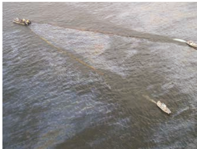
▲ Figura 30: barco de recolección con correa desplegado con barrera y remolcadores en una configuración en V.
