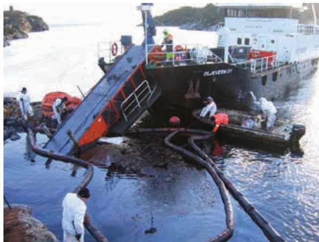
▲ Figura 15: skimmer de correa sobre una embarcación grande de recolección. La correa, fabricada con una malla, permite que el agua se escurra y fomenta la adhesión de los hidrocarburos. Los hidrocarburos se levantan para llevarlos a bordo y se raspan para retirarlos de la correa e introducirlos en el almacenamiento.
