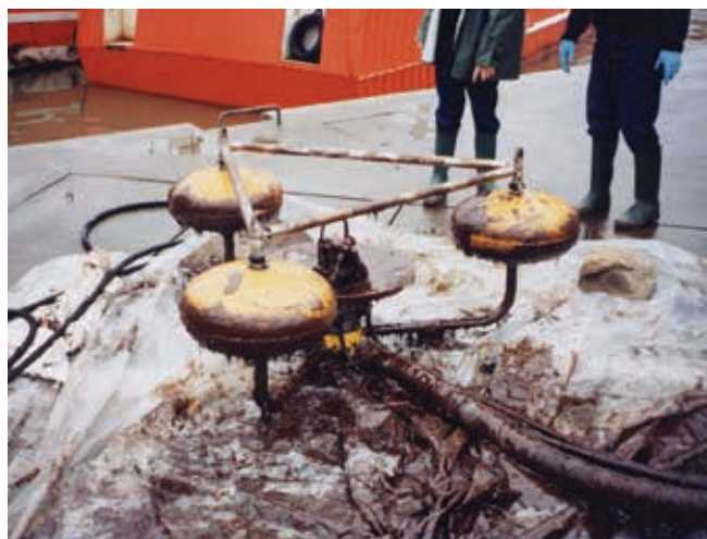
▲ Figura 37: skimmer tipo vertedero trasladado a tierra después de la recolección de hidrocarburos pesados. Después de la desmovilización, los equipos deben limpiarse y revisarse para que estén listos para futuros usos.
