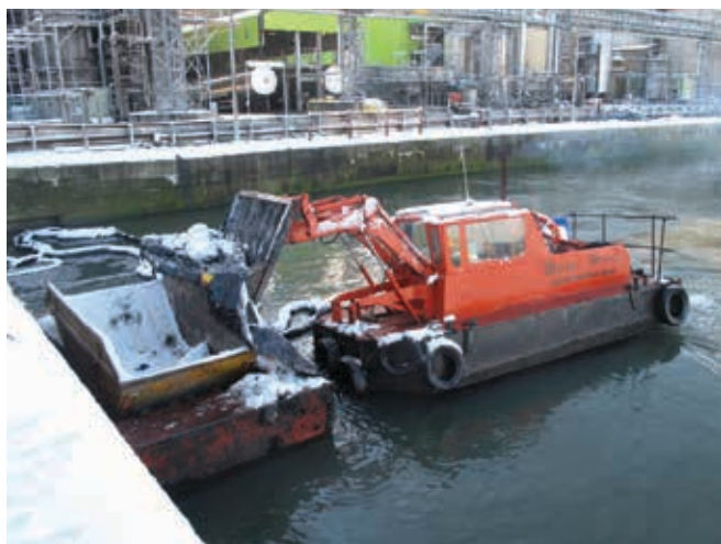
▲ Figura 35: embarcación autopropulsada que se utiliza habitualmente para recolectar desechos en un puerto. En este caso, la baja temperatura y el punto de fluidez relativamente alto de los hidrocarburos provocaron que estos se volvieran semisólidos, y que tuvieron que ser retirados mediante recogedores y cucharas hasta un contenedor flotante.
