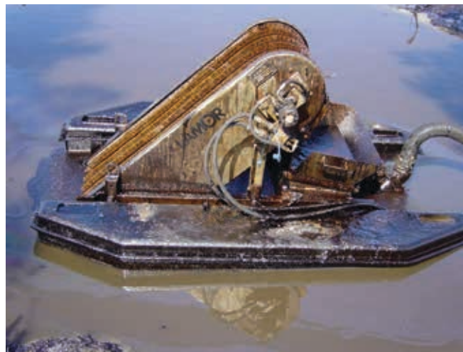
▲ Figura 5: skimmer de cepillo flotando libremente. Los hidrocarburos se adhieren a los conjuntos de cepillos giratorios y se levantan de la superficie del agua. Un peine retira los hidrocarburos de los cepillos hasta el almacenamiento. Una hélice situada detrás del cepillo atraen los hidrocarburos flotante hacia el skimmer para mejorar la tasa de encuentro y el rendimiento (imagen gentileza de Lamor).
