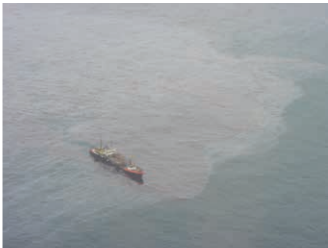
▲ Figura 18: embarcación de recolección en una mancha grande y homogénea de hidrocarburos gruesos, lo que permite un uso muy eficaz de los recursos
