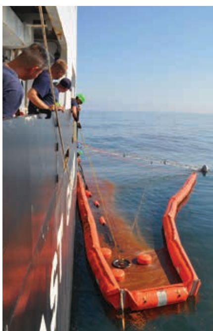
▲ Figura 29: barrera remolcada en una configuración en U con un skimmer desplegado desde la embarcación de recolección principal.
