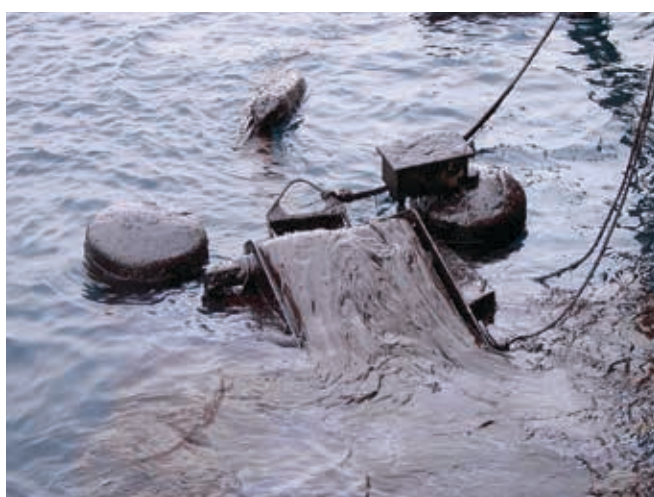
▲ Figura 16: incorporación de un adaptador de correa para mejorar la capacidad del skimmer tipo vertedero base en fueloil muy emulsionado. La elevada viscosidad de los hidrocarburos impedía su flujo hacia, y sobre, el labio del vertedero. Para evitar esto, los hidrocarburos de la correa dentada “agarraban” los hidrocarburos para mejorar la eficiencia; la energía de cohesión de los hidrocarburos hace que los hidrocarburos restantes fluyan hacia el skimmer (imagen gentileza de Ro-Clean Desmi/Armada Danesa).
