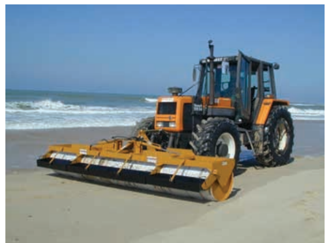
▲ Figura 36: skimmer de tambor oleofílico instalado en un tractor, que se utiliza para retirar bolas de alquitrán frescas sobre una playa arenosa compactada (imagen gentileza de Le Floch Dépollution).
