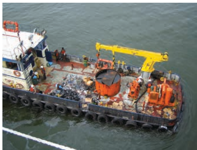
▲ Figura 24: barco de trabajo con almacenamiento limitado para los hidrocarburos retirados sobre la cubierta.
