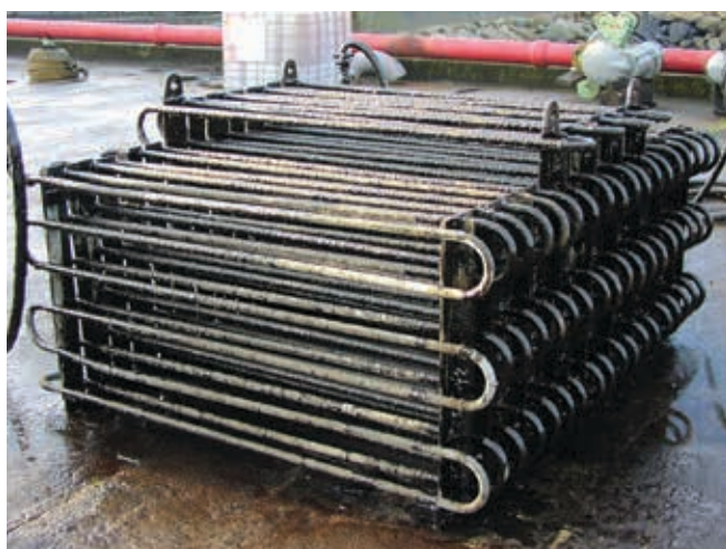
▲ Figura 27: uso de un serpentín de calefacción para ayudar a la descarga de hidrocarburos viscosos desde embarcaciones de recolección hasta la orilla.
