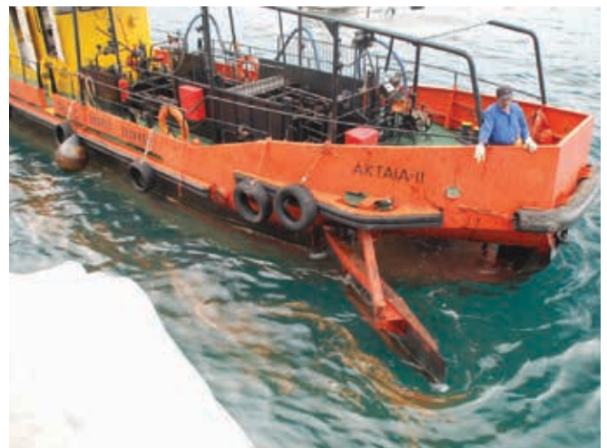
▲ Figura 1: skimmer tipo vertedero autopropulsado para uso en puertos y aguas cerca de la costa. Las puertas de proa se abren para mejorar el ancho de barrido y permitir la entrada de hidrocarburos flotantes. Los hidrocarburos recolectados se bombean hasta un depósito de almacenamiento interno.
