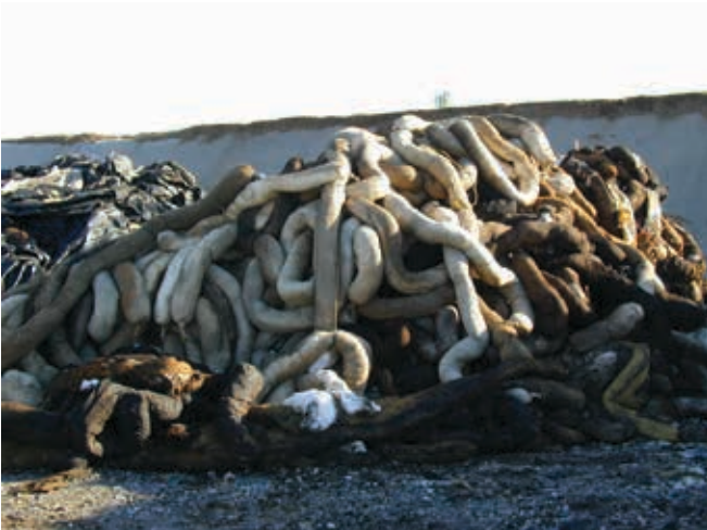
▲ Figura 15: uso de adsorbente acumulado en un sitio de almacenamiento temporal. La compresión provocará que los hidrocarburos recolectados se escurran de la barrera y deberá prestarse atención para evitar contaminación secundaria.
