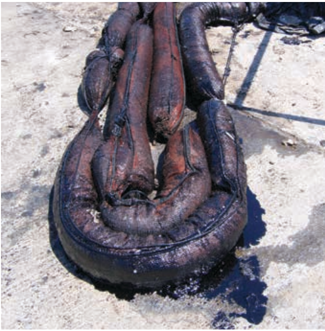
▲ Figura 14: la lixiviación de hidrocarburos de una barrera adsorbente recuperada es una fuente de contaminación secundaria.
