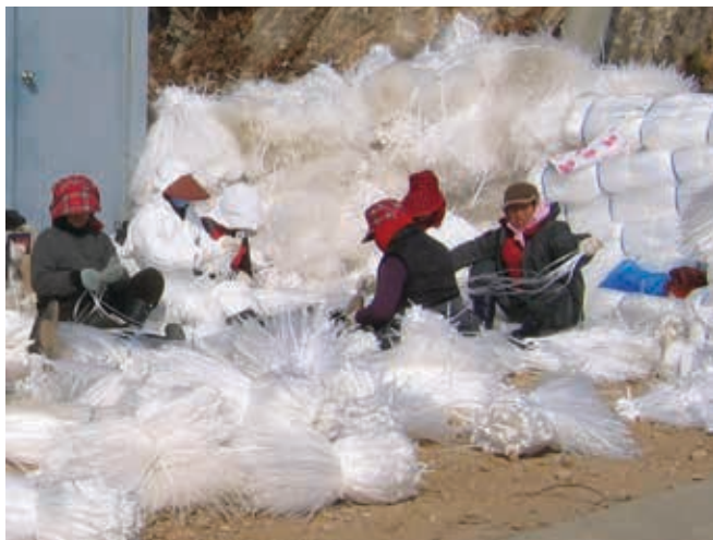
▲ Figura 6: habitantes locales construyen trampas a partir de bandas de polipropileno. Pueden obtenerse rentabilidades en términos de precio y eficiencia en el transporte mediante la fabricación de adsorbente a partir de materiales disponibles localmente.
