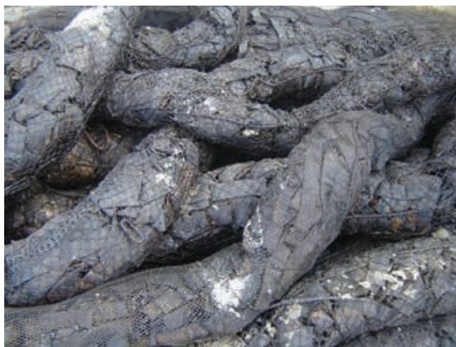
▲ Figura 3: bandas de polipropileno encerradas en redes. Es posible que la estructura suelta y no homogénea de la barrera permita los hidrocarburos penetrar rápidamente en la estructura, lo que facilita que las superficies interiores los adsorban aunque las redes de contención pueden dañarse con facilidad.
