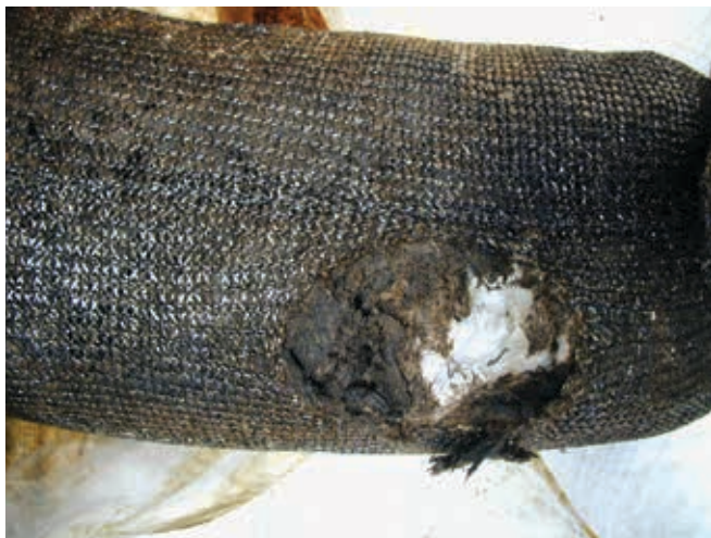
▲ Figura 4: sección transversal de una barrera continua y homogénea que muestra únicamente un uso parcial. El volumen interior no está contaminado por hidrocarburos, bien porque la barrera ha estado desplegada durante un periodo de tiempo insuficiente o porque los hidrocarburos son demasiado viscosos para penetrar en la estructura.
