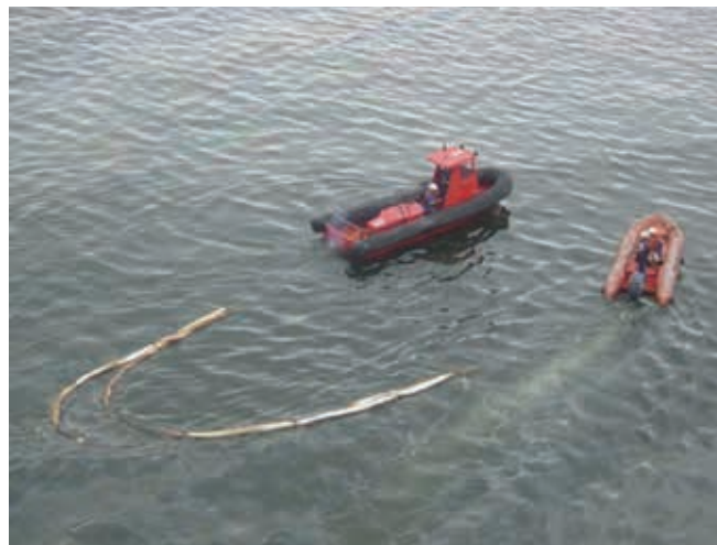
▲ Figura 12: barrera adsorbente remolcada en una configuración en "U" detrás de dos embarcaciones, con el propósito de retirar brillos (películas de hidrocarburos muy finas) en el mar. La saturación de la barrera con agua de mar reduce su eficacia y la ausencia de un faldón en la barrera limita la capacidad para contener hidrocarburos. En este caso puede observarse escapes de brillos de la barrera.
