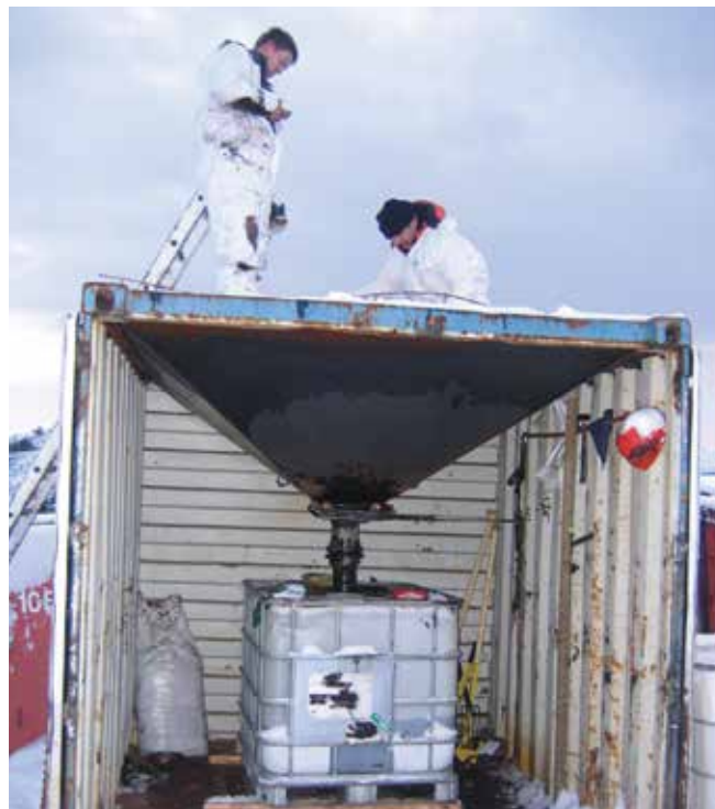
▲ 図16：間に合わせで作成された廃棄物濾過装置。回収油を格子付き漏斗に通して、ゴミを取り除く。
