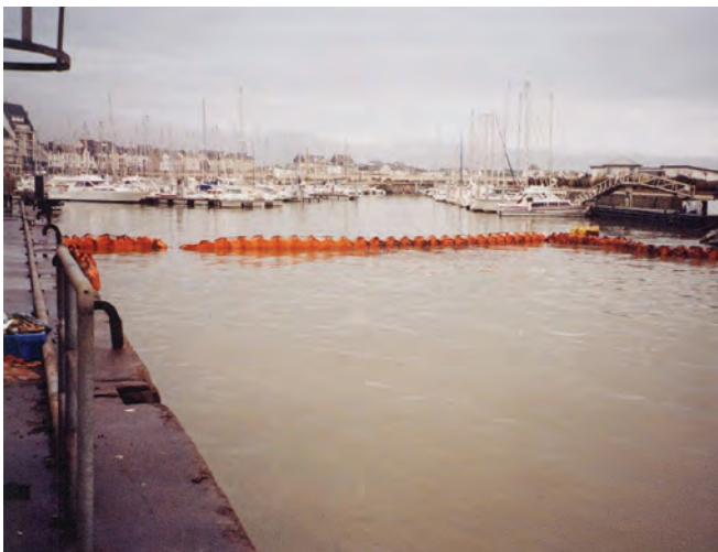
▲ 그림 2: 선박의 입출항으로차단막이 손상되면 마리나 어귀를 성공적으로 차단하기 어렵다.
