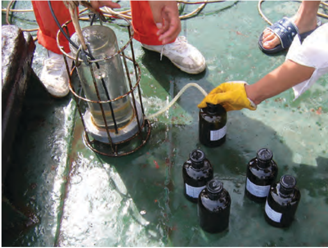
▲ 그림 8: 시료 분리를 위해, 물 시료들을 시료 수집 장치에서 유리병으로 나눠 담음
