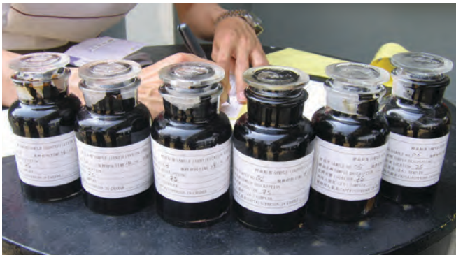
▲ 그림 11: 라벨을 잘 붙인, 입구가 넓은 유리병의 병커유 시료들 (이 경우 하나의 탱크에서 시료들을 나누어 담음).
