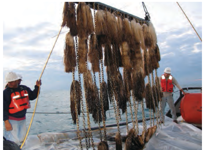
▲ 그림 3: 조하대 시료 채취를 위해 흡착재를 사용함. 흡착재가 부착된 틀이 해저에서 예인된다. 흡착재가 올라왔을 때 유류의 존재 여부를 보고 침강유의 지리적 범위를 결정할 수 있다.
