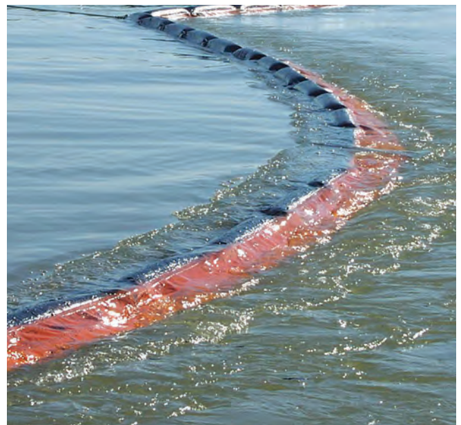
▲ 그림 4: 강한 조류로 인해 오일펜스가 기울어지면서 기름이 스커트 아래로 유실된다.
