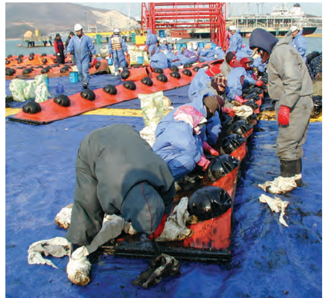
▲ 그림 6: 펜스형 오일펜스의 외장형 부유체 뒤편에 걸린 기름은 특히 세척하기가 어렵다.
