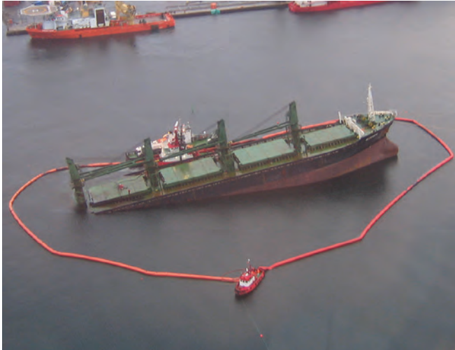
▲ 그림 12: 일부가 가라앉은 선박 주위에 계류되어 있는 팽창식 오일펜스. 새어 나올 수 있는 뱅커유의 포집을 위한 것이다.
