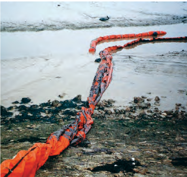
▲ 그림 5: 오일펜스는 설치 후 쉽게 손상될 수 있다. 조석 주기 전체에 걸쳐 효과를 제대로 발휘할 수 있도록 정기적인 점검이 필요하다.
