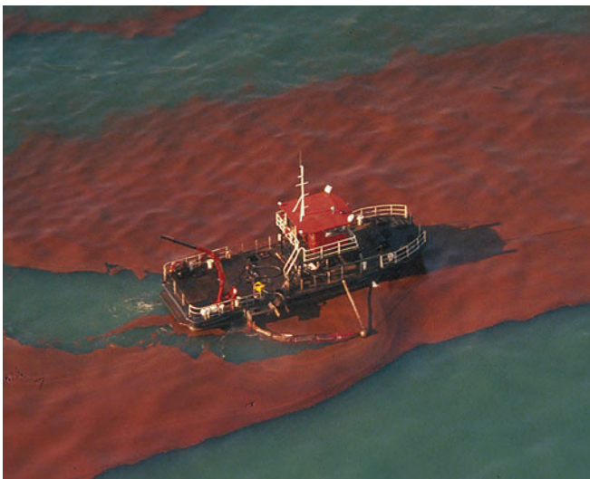
▲ 그림 10: 단일 선박에 의한 기름 회수 시스템. 예멸전화가 심한 원유를 회수하기 위해 길이가 짧은 커튼형 오일펜스가 쌍동선에 의해 설치되어 있다.
