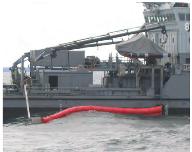
▲ 그림 11: 파도의 작용에 적응할 수 있을 만큼 유연한 오일펜스이지만 선체와 연결된 부위가 수면 위로 올라와 있어서 상단정점 부분으로 기름이 유실될 가능성이 있다.
