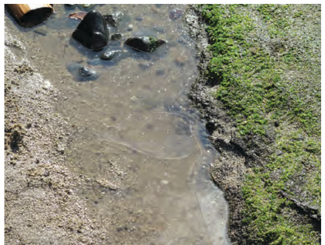
▲ 그림 7: 윤활유 제조에 사용되는 투명한 기유(base oil)는 물의 표면에서 원형 렌즈를 형성한다. 이 기름은 무색이기 때문에 정량화하기 어렵다.
