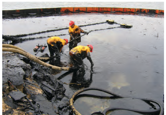
▲ 그림 3: 목형 유회수기와 펌프를 이용하여 유동성 중질유 기름의 회수
