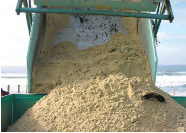
▲ 그림 7: 중장비를 이용한 직접적인 회수는 깨끗한 모래를 많이 수거하게 되고 폐기물 중의 기름의 농도가 매우 낮을 수 있음
