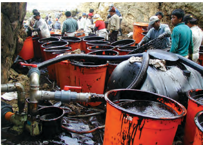
▲ 그림 13: 바위 해안에서 회수된 기름은 개방형 통에 일시적으로 보관을한다. 펌프를 이용하여 해안상부로 이송하고 탱크로 이송한다.
