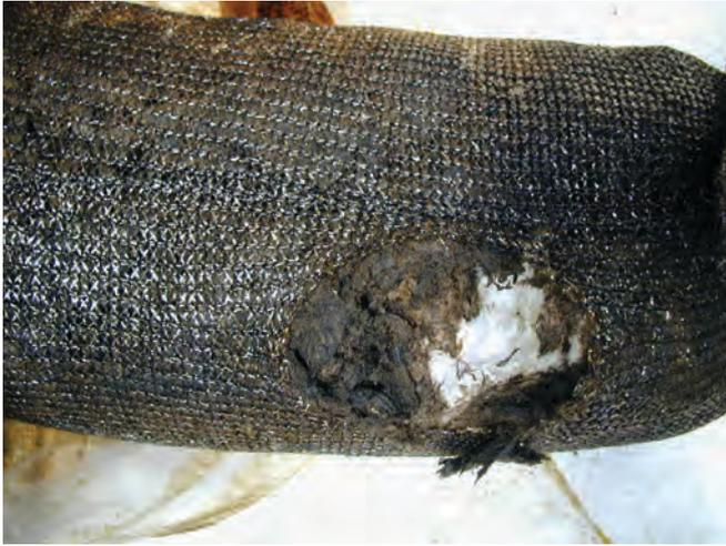
▲ 그림 4: 연속적이고 균일한 붐형 유흡착재의 찢어진 표면. 일부만이 사용되었음을 알 수 있다. 내부에는 기름이 함유되어 있지 않다. 유흡착재의 사용 시간이 너무 짧았거나, 기름의 점도가 너무 높아서 내부 구조로 침투하지 못했기 때문이다.
