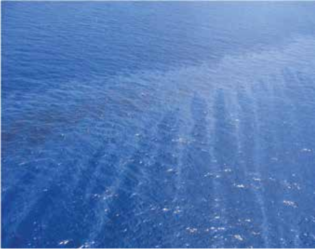
▲ Şekil 10: Resmin sol tarafından sağ tarafına doğru bir siya petrol şeridi gözlemlenmektedir. Petrol üzerine esen rüzgar bu şeridi gözlemciden uzağa itmektedir, rüzgarın neden olduğu değişiklik gösteren parlaklıkta dikey kümelerle sonuçlanmaktadır.
