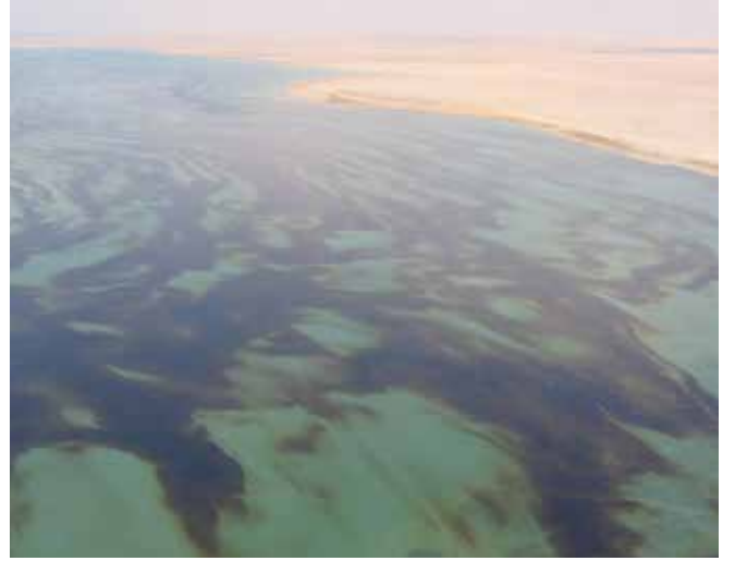
▲ Şekil 11: Ağır yağ yakıtın su yüzeyinde çok geniş kesikli tabakaları - parlaklık olmadığına dikkat ediniz.
