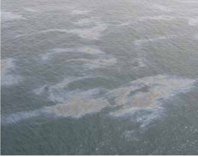
▲ Şekil 8 ve Şekil 9: Bir uçaktan gözlemlenen ve daha sonra aynı günde bir gemiden (sağda) çok yakından gözlemlenen orta dereceli yağ yakıtın (IFO 180) kazara dökülmesinden kaynaklanan büyük parlak benekler. Benekler, yanardöner parlaklıktaki ve oradan da gümüş renkte parlaklıktaki alanlara doğru yayılan ince petrol tabakalarından oluşan alanlar içermektedir.
