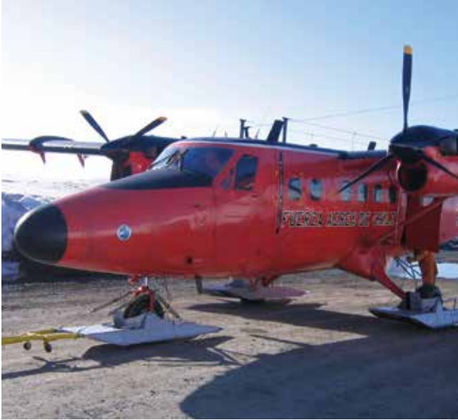
▲ Şekil 2: Çift motorlu sabit kanatlı, kanatları üste monteli uçaklar denizde petrolün havadan gözlemlenmesi için mükemmel ortamlardır. Hareket kabiliyetlerinin daha fazla olması ve hızlarının daha yavaş olması nedeniyle sahile daha yakın gözlem için helikopterler tercih edilebilir.
