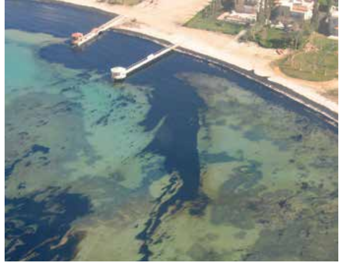
▲ Şekil 15: Sahil şeridine ulaşan ağır yağ yakıt. Deniz dibi yosunu ve deniz yatağı kaya oluşumları, petrol miktarının tahminlerinde yanıltıcı olabilmektedir.
