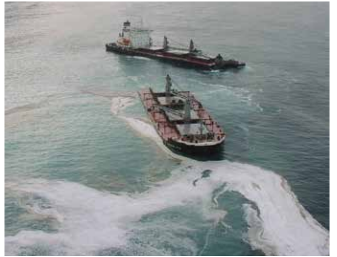
▲ Şekil 13: Dökme yük taşıyan bir geminin felaket feci bir şekilde arızalanmasının bir sonucu olarak dökülen ağır yağ yakıt. Yük, petrolle karışmıştır, dökülen petrol hacminin gerçekçi tahminlerinin yapılmasını güçleştirmektedir.
