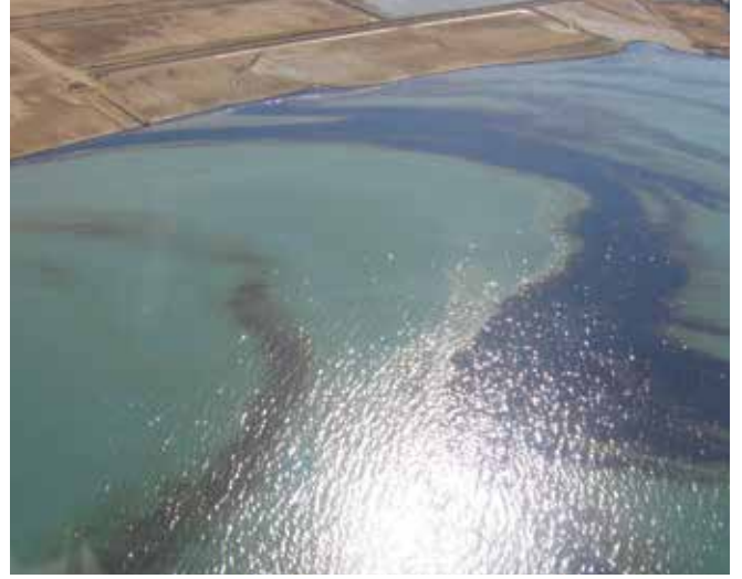
▲ Şekil 21: Denizden ışık yansıması bazen havadan fotoğraf çekerken bir sorun olabilmektedir; morötesi ve kutuplandırıcı filtreler petrolün görsel tanımının netleştirilmesine yardımcı olabilmektedir.
