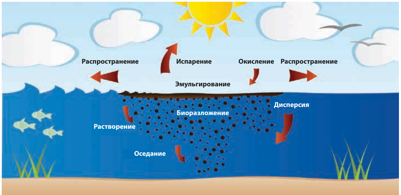
▲ Рис. 4: Процессы выветривания, действующие на нефть в море. После прибывания нефти к береговой линии некоторые из этих процессов перестают действовать.
