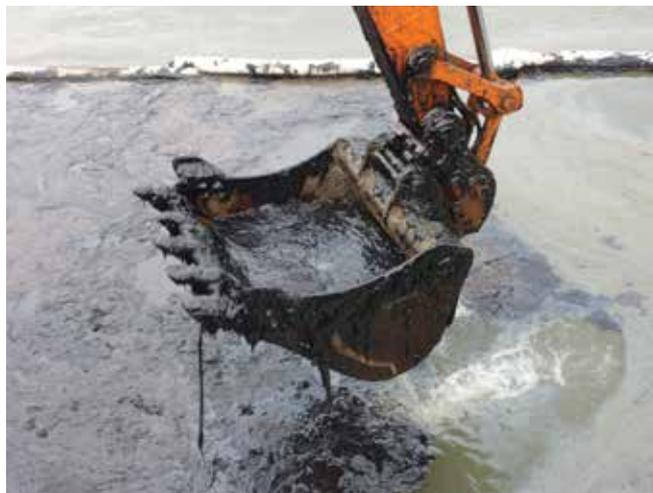
▲ Рис. 21: Применение экскаватора для сбора высоковязкой топливной нефти. Концентрация собираемой нефти была повышена выдачей оператору инструкции о том, чтобы короткое время удерживать ковш над поверхностью, давая стечь забранной воде. Это снизило затраты на последующую утилизацию за счет эффективности сбора.
