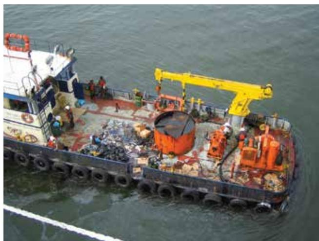
▲ Рис. 24: Рабочее судно с ограниченной емкостью для хранения нефти на палубе.
