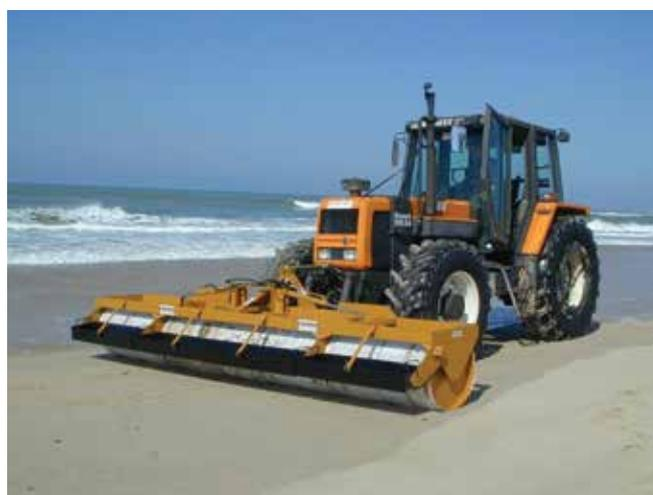
▲ Рис. 36: Смонтированный на тракторе олеофильный барабанный скиммер используется для сбора свежих смолистых шариков на пляже с плотным песчаным покрытием (любезно предоставлено Le Floch Dépollution).
