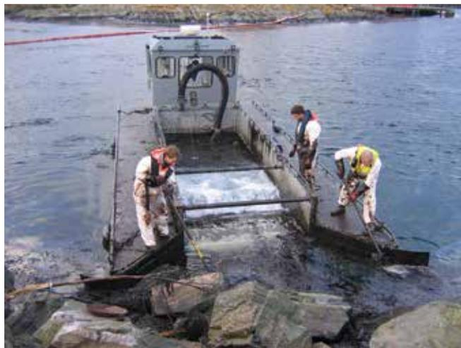
▲ Рис. 34: Самоходный водосливный скиммер собирает нефть в укрытой скалистой бухте. Малая осадка судна позволяет работать близко к берегу. Операторы помогают, подгоняя нефть в выпуск водослива.
