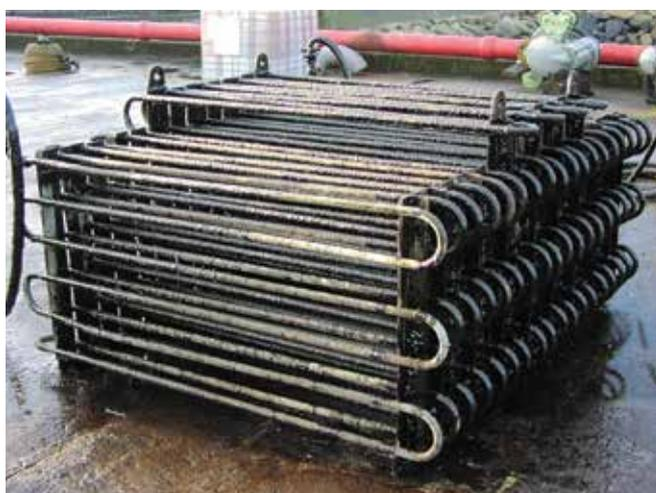
▲ Рис. 27: Мобильный нагревательный змеевик, используемый для облегчения перекачки вязкой нефти с судна на берег.
