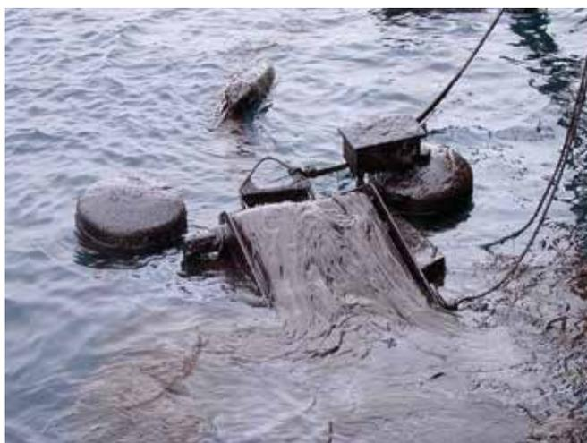
▲ Рис. 16: Переходник ленты добавлен для повышения пропускной способности базового водосливного скиммера в высоко эмульгированной топливной нефти. Высокая вязкость нефти препятствует ее протеканию к кромке и поверх кромки водослива. Вместо этого зубчатый переходник ленты захватывает нефть, повышая эффективность сбора. Энергия сцепления нефти заставляет остающуюся нефть протекать к скиммеру (любезно предоставлено Ro-Clean Desmi/Danish Navy).
