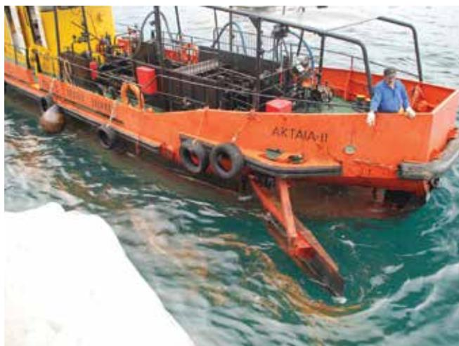
▲ Рис. 1: Самоходный водосливный скиммер, используемый в портах и прибрежных водах. Носовые ворота раскрываются, расширяя полосу захвата и открывая вход для плавающей нефти. Собранная нефть перекачивается во внутренний накопительный бак.
