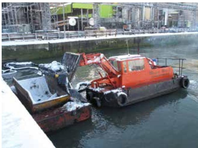
▲ Рис. 35: Самоходное судно, обычно используемое для сбора мусора в порту. В этом случае низкая температура и относительно высокая точка застывания нефти сделали нефть полутвердой, что потребовало сбора черпаками с выгрузкой в плавучий скип.
