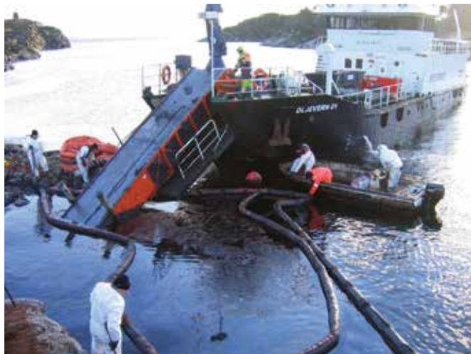
▲ Рис. 15: Ленточный скиммер, установленный на большом судне. Лента, изготовленная из сетки, позволяет отток воды и способствует прилипанию нефти. Нефть поднимается на борт и счищается в накопительный бак.
