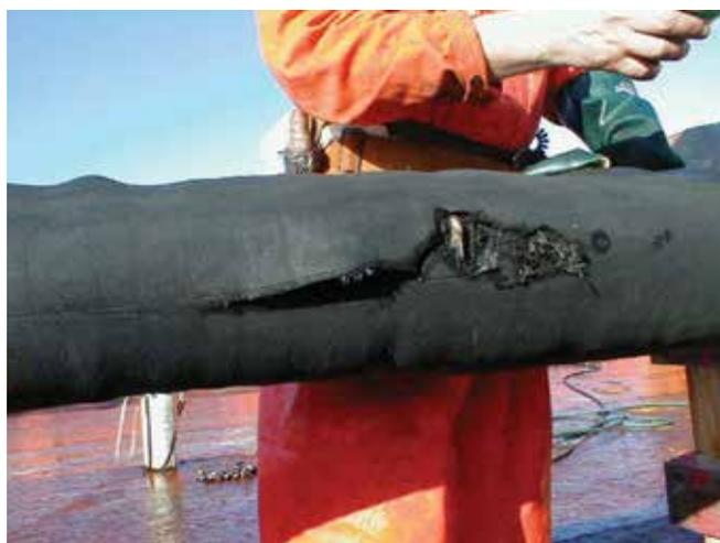
▲ Рис. 23: Разрыв рукава, вызванный чрезмерным внутренним давлением от прокачки высоковязкой нефти (любезно предоставлено NOFO).
