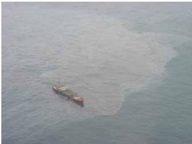
▲ Рис. 18: Судно-участник операции сбора нефти, расположенное в большом однородном пятне толстого слоя нефти, обеспечивает высокую эффективность использования ресурсов.
