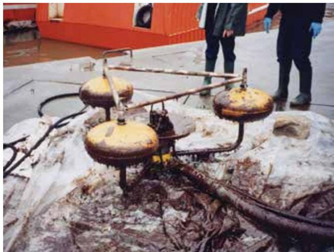
▲ Рис. 37: Водосливный скиммер, доставленный на берег после сбора тяжелой нефти. После использования оборудование подлежит очистке и осмотру для приведения в готовность для последующего использования.
