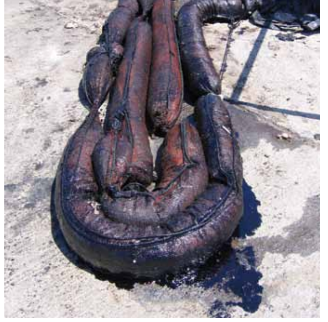
▲ الشكل رقم 14: النفط المتسرب من حاجز تطويق طافي ماص تمت استعادته يعتبر مصدرًا للتلوث الثانوي.
