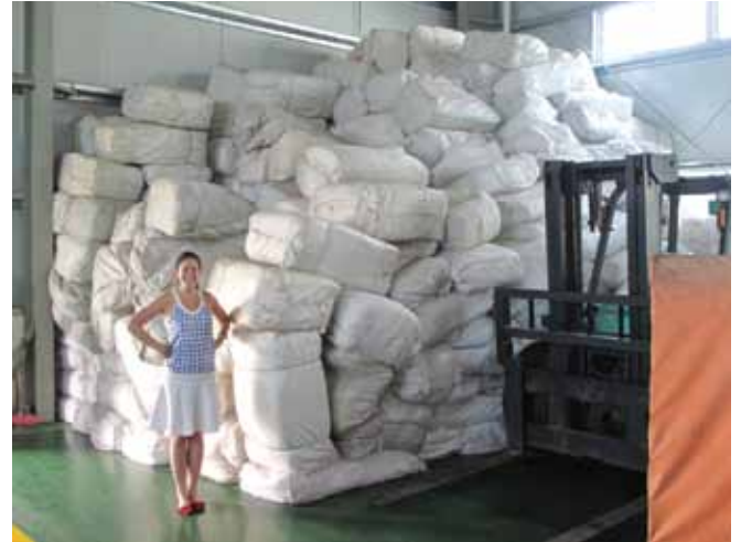
▲ الشكل رقم 8. تعتبر المواد الماصة بطبيعتها مواد كبيرة الحجم. ويمكن أن يسبب النقل والتخزين قبل الاستجابة للانسكاب وأثنائها وبعدها مشكلات من ناحية التكلفة والترتيبات اللوجستية.
