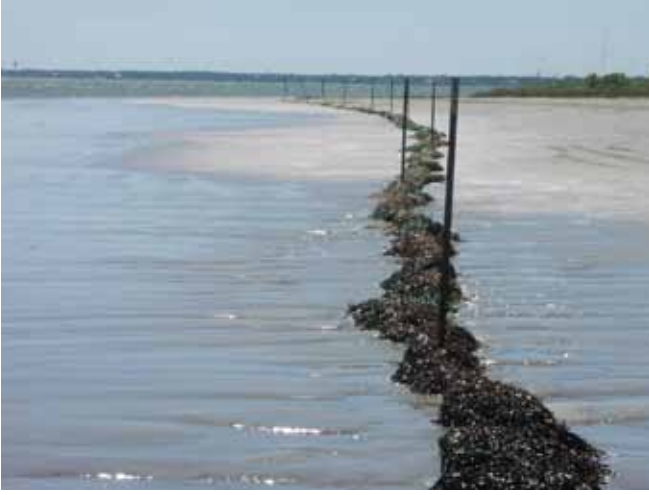
▲ الشكل رقم 7: شبكة معلقة بطول مصب نهر لالتقاط النفط الطافي. الهيكل المفتوح والمساحة السطحية الكبيرة للمادة يناسبان استعادة أنواع النفط اللزجة على وجه الخصوص.
