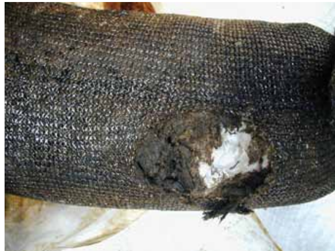
الشكل رقم 4: تم قطع وإزالة سطح حاجز تطويق طافي ماص متجانس ومتصل لبيان أنه لم يستخدم إلا جزئياً. يظل الحجم الداخلي غير ملوث بالنفط، إما بسبب استخدام حاجز التطويق الطافي لفترة غير كافية، أو نظراً لأن لزوجة النفط مرتفعة إلى درجة لا تسمح له باختراق البنية.
