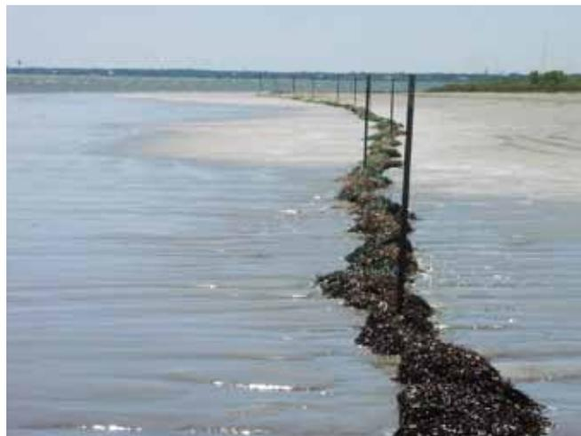
▲ 图 7：溢油吸收丝团排成一列在河口捕获漂浮油。材料的开放结构和大表面区域尤其适合用于回收粘性油类。
