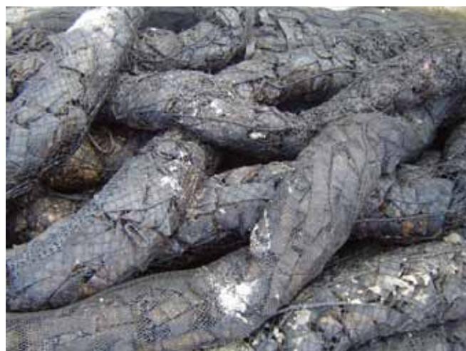
▲ 图 3：封装在编网中的聚丙烯条。浮木档栅松散的不均匀结构能够让油类轻松穿透结构，从而让内表面能够吸附油类，但封装编网很容易损坏。
