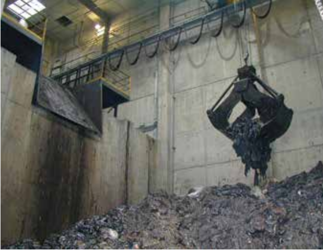
▲ Şekil 19: Evsel atıkla birlikte eşzamanlı olarak bertaraf için büyük bir sanayi türü çöp yakma fırınının yükleme bacasının içerisine beslenmekte olan petrol bulaşmış çuvallar.
