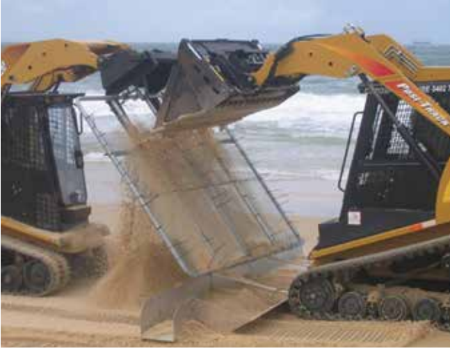
▲ Şekil 17: Meydana gelen atık miktarının azaltılması amacıyla katran toplarının kumdan mekanik olarak elenmesi.
