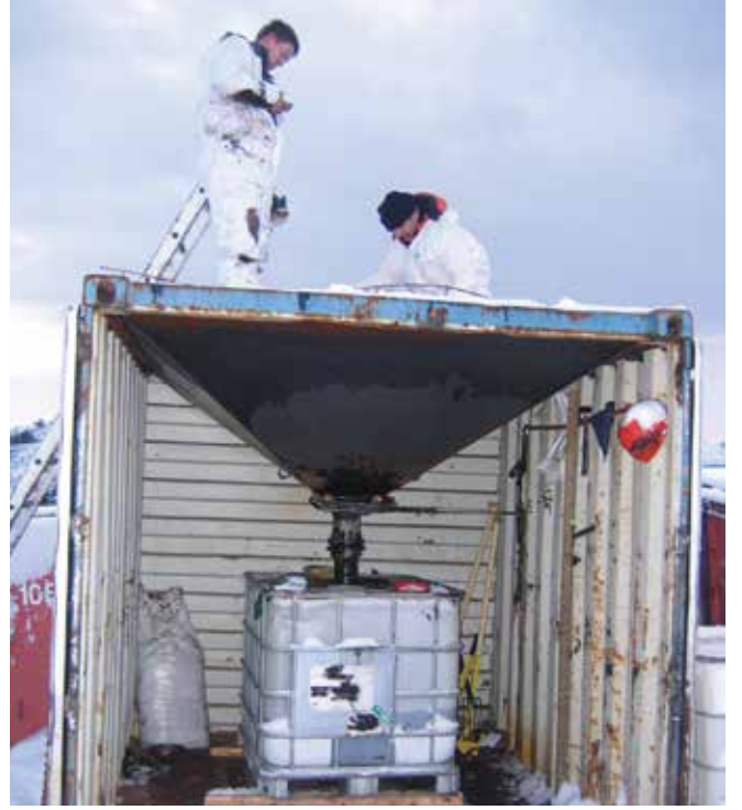
▲ Şekil 16: Toplanan petrolün, döküntünün süzülmesi için ızgaralı bir huninin içerisinden geçtiği eğreti bir atık süzme sistemi.
