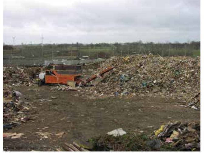
▲ Şekil 20: Katı atık sahası tesisi. Petrol yoğunlukları düşük olan atık dikkatli bir şekilde kontrol edilen koşullar altında evsel atıkla birlikte yerleştirilebilmektedir.
