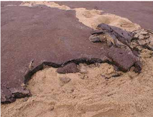
▲ Şekil 5: Kıyıda kum üzerine oturmuş sütsüleşmiş petrol. Kaldırılan temiz alt katman miktarının en aza indirilmesine hizmet eden elle uygulanan seçici toplamaya hizmet etmektedir.
