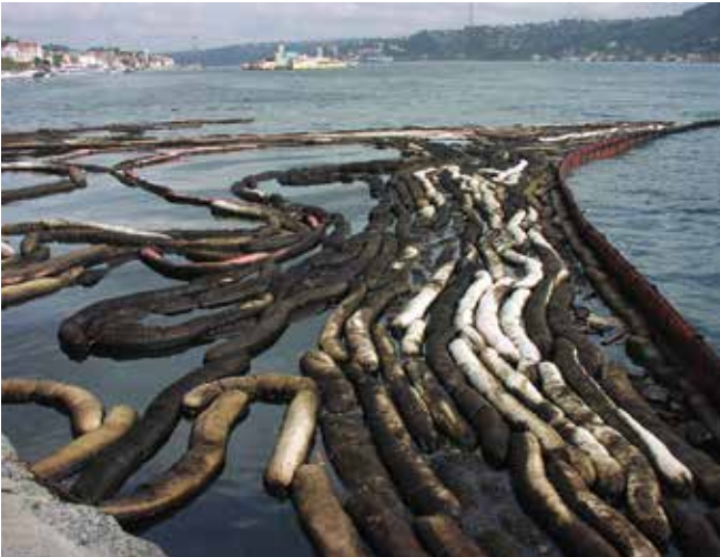
▲ Şekil 7: Kısmen petrol bulaşmış olan emici maddeden engel. Atık üretiminin en aza indirilmesi için emici malzemelerin büyük ölçekli kullanımından kaçınılması gerekmektedir.
